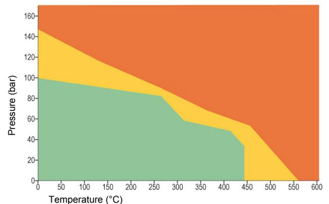
Das P x T Diagramm gibt den möglichen Einsatzbereich der Type **NA-1122** in Bezug auf Druck- und Temperaturverhältnisse an. Der grüne Bereich entspricht dem normal zulässigen Anwendungsbereich. Der orangefarbene Bereich zeigt die maximal zulässigen Werte an. Für Einsätze in diesem Bereich ist eine Überprüfung durch unsere technische Abteilung unbedingt notwendig.
